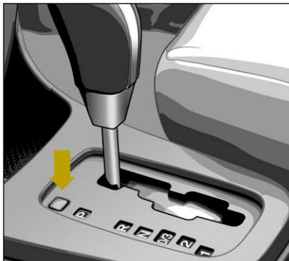
배터리 방전등으로 **P**에서 변속 레버가 움직이지 않을 때는 주차 브레이크를 걸고 브레이크 페달을 밟으면서 다음과 같은 요령으로 해제합니다.
