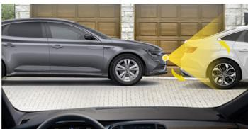
주요 기본 품목 일부 수입차 및 고급차에만 적용되는 시스템으로, 마치 하늘에서 바라보는 듯한 버드뷰를 2D/3D 모드로 즐기실 수 있습니다. 3D 모드는 화면을 손으로 터치하는 방식으로 차량 주변을 보다 넓게 확인할 수 있습니다. 카메라는 총 4개(전방, 후방 및 좌/우측 아웃사이드 미러 하단부)가 장착됩니다.
